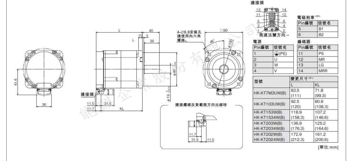
注) 1.()內的數值為電磁剎車型的尺寸。 2.電磁剎車端子(B1,B2)不分極性。 3.不論有無油封,外部尺寸皆相同。 4.請使用聯軸器連接負載。
