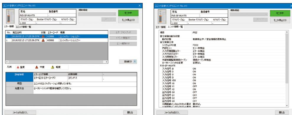
バッファメモリで安全機器の設定内容や入出力の状態を確認でき、安全制御の状態(装置の安全稼動時、非常停止時)で一般制御の動作を変更できます。安全増設ユニットでは、CPUユニットから状態をモニタできるため、シーケンスプログラムで設定内容を確認し、対処方法を作業者に通知することもでき、復旧時間の短縮にも活用できます。
