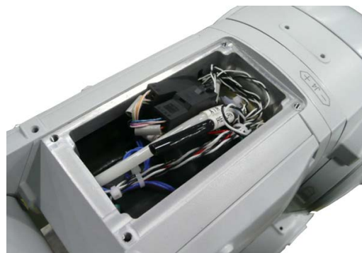
2 号机械臂盖板内的电缆收纳状态
