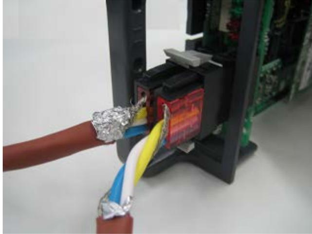
图6-8 多台连接时的通信用快速连接器的连接示例
