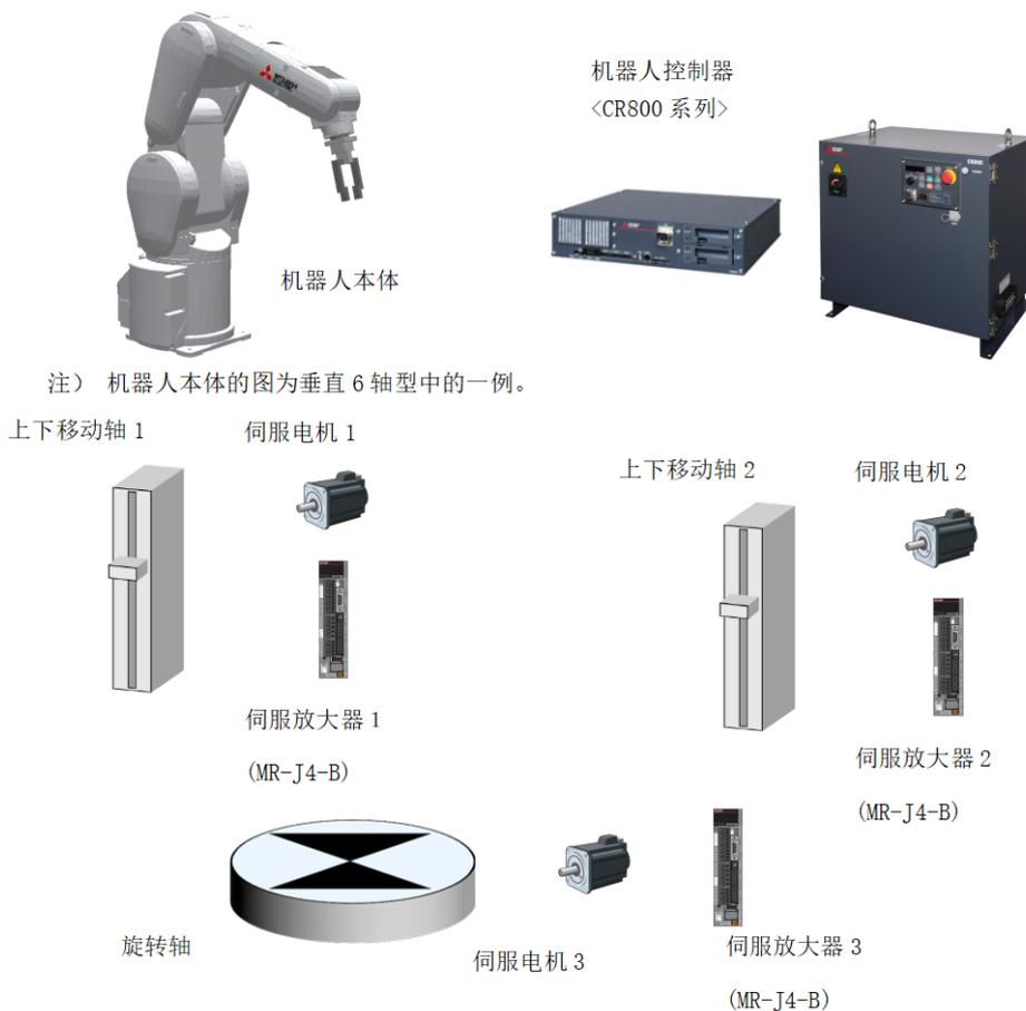
图 3.2.3 多轴的系统（示例）
