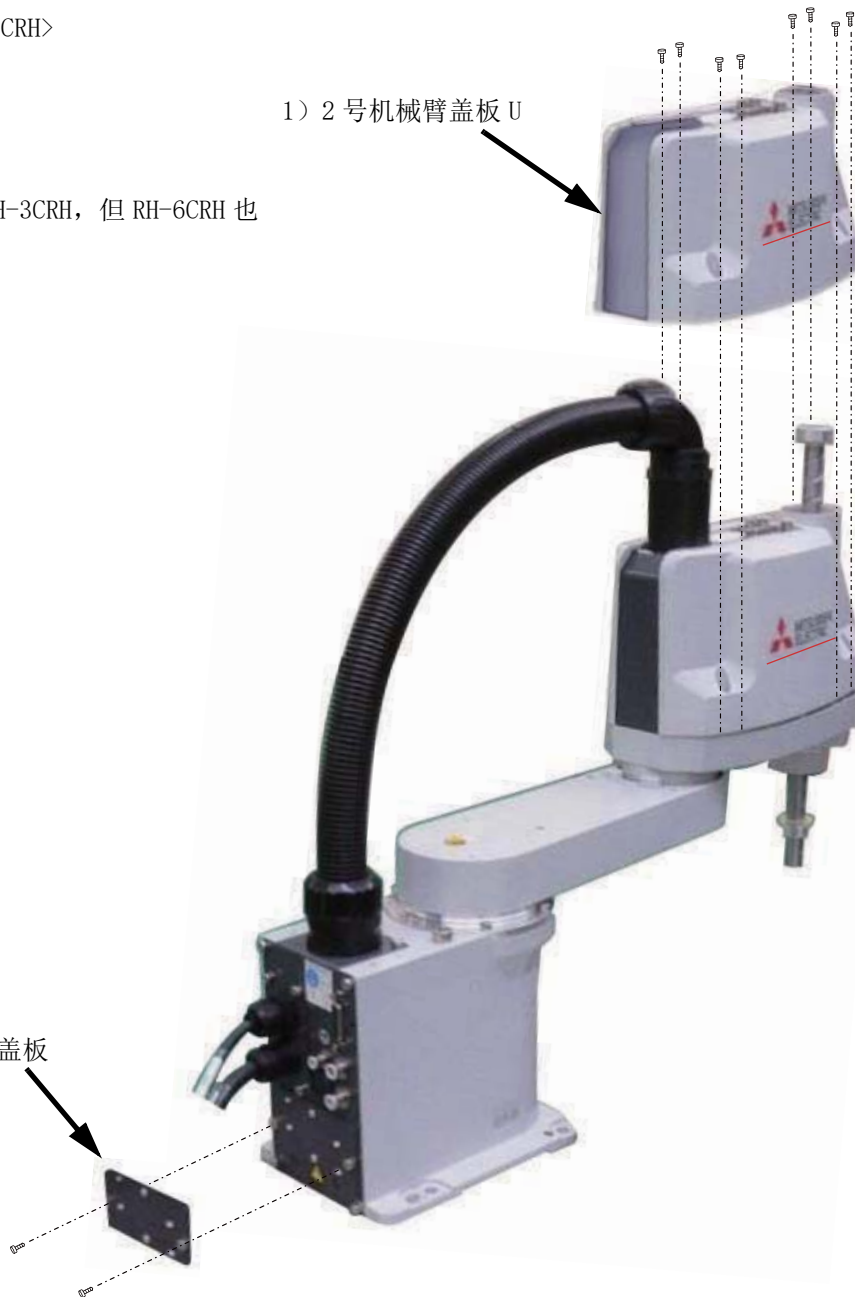
图 5-2: 盖板的拆装方法 (RH-3CRH、RH-6CRH)
