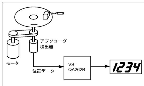
図5.1 VS-QA262B使用例
