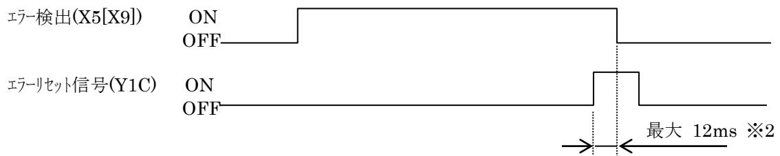
※2 リモートI/O接続時の応答時間は、リモートI/Oネットの伝送遅れ時間が加算されます。
