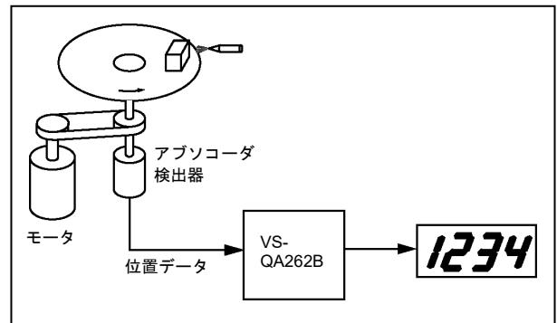
図5.1 VS-QA262B使用例
