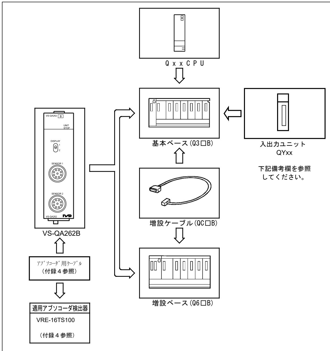
図2.1 VS-QA262Bシステム構成図
