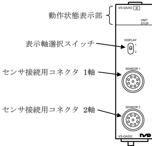
VS-QA262Bの動作状態表示部の機能
