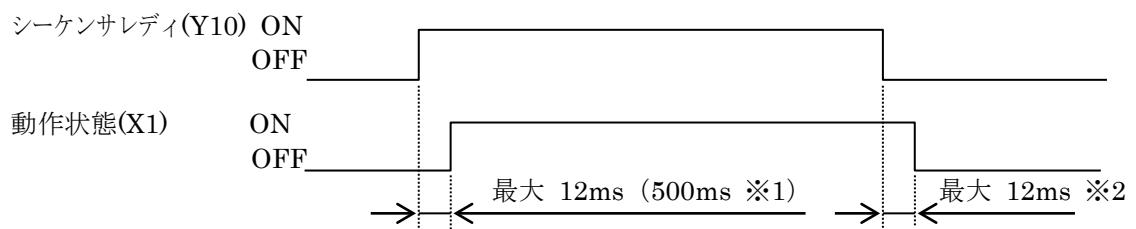
※1 電源投入及びシーケンサCPUのリセット解除後、500msの間は、シーケンサレディ信号(Y10)をONしてもオンラインしません。
