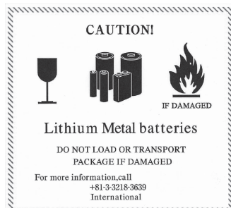
図1 当社電池イラスト入り取扱いラベル例 (2018年12月31日まで使用可能)
