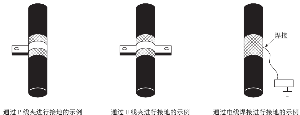
通过 P 线夹进行接地的示例
