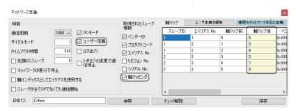
軸マップのスレーブIDが同じものは多軸サーボアンプを表し、上からA軸、B軸、C軸の順になります。
