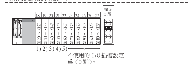
從 PLC CPU 看到的 GOT 連接用擴充段數的示意圖 (佔用 16 點 × 10 的插槽)
