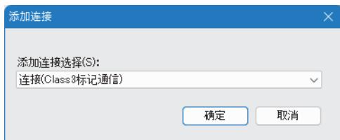
3. 在“连接详细设置”中设置Class3标签通信的参数。(☞ 112页 始发者：Class3标签通信)
