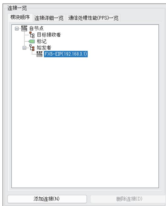
2. 从“添加连接选择”中选择实例通信的连接<sup>\*1</sup>后，点击[确定]按钮。
