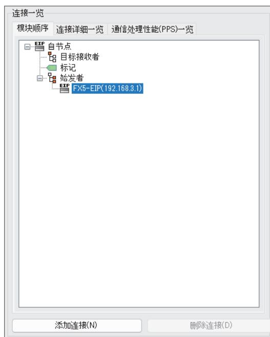
2. 从“添加连接选择”中选择标签通信的连接<sup>\*1</sup>后，点击[确定]按钮。
