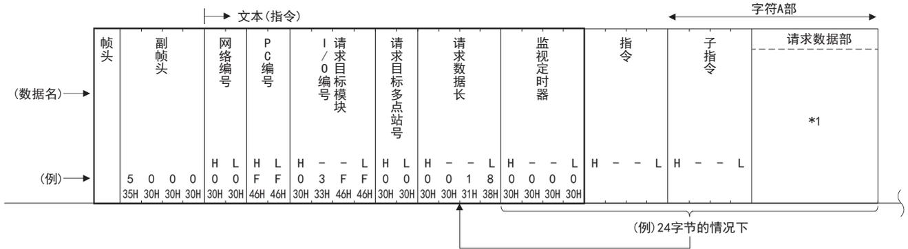
以太网搭载模块侧 → 对象设备侧 (响应报文)
