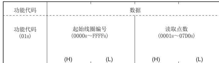
图 4.9 线圈读取 (请求报文)
