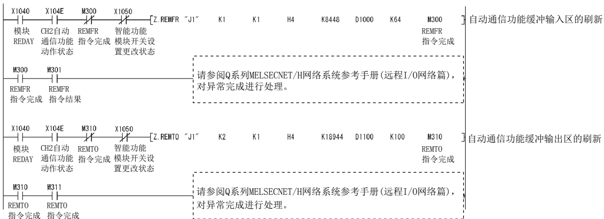
图 9.39 安装到 MELSECNET/H 远程 I/O 时的数据传送程序示例
