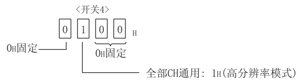
图 9.7 智能功能模块开关设置：分辨率设置
