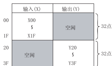
输入与输出的 I/O 地址号使用连号的类型(使用 QX41Y41P 时)
