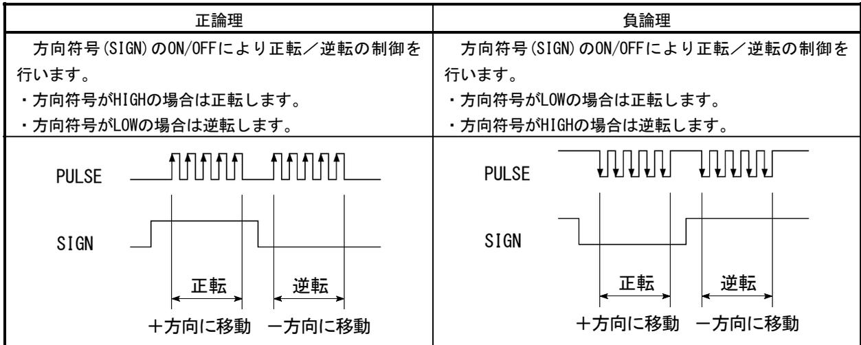
※PULSEは外部入出力信号の「PULSE F」，SIGNは「PULSE R」から出力されます。（「3.4.3項」参照）
