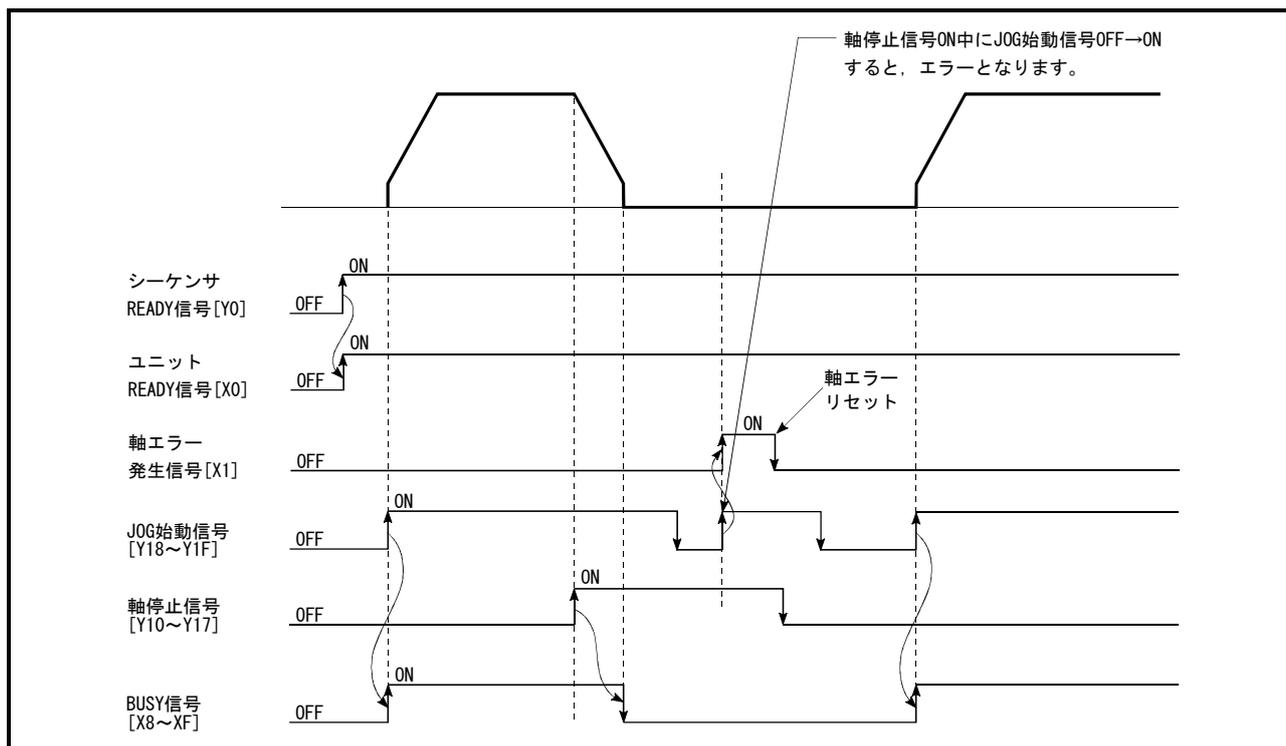
図10.2 JOG運転中に軸停止信号がONされた場合の動作
