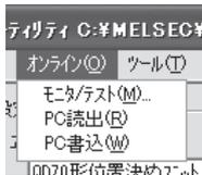
[モニタ/テスト] : モニタ/テストユニット選択画面を起動させます。
