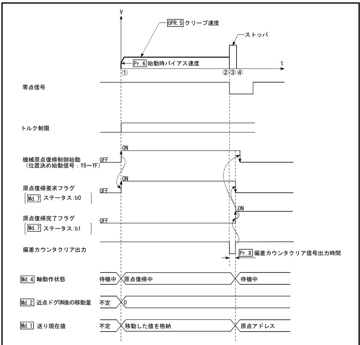
図8.8 ストップ3の機械原点復帰制御
