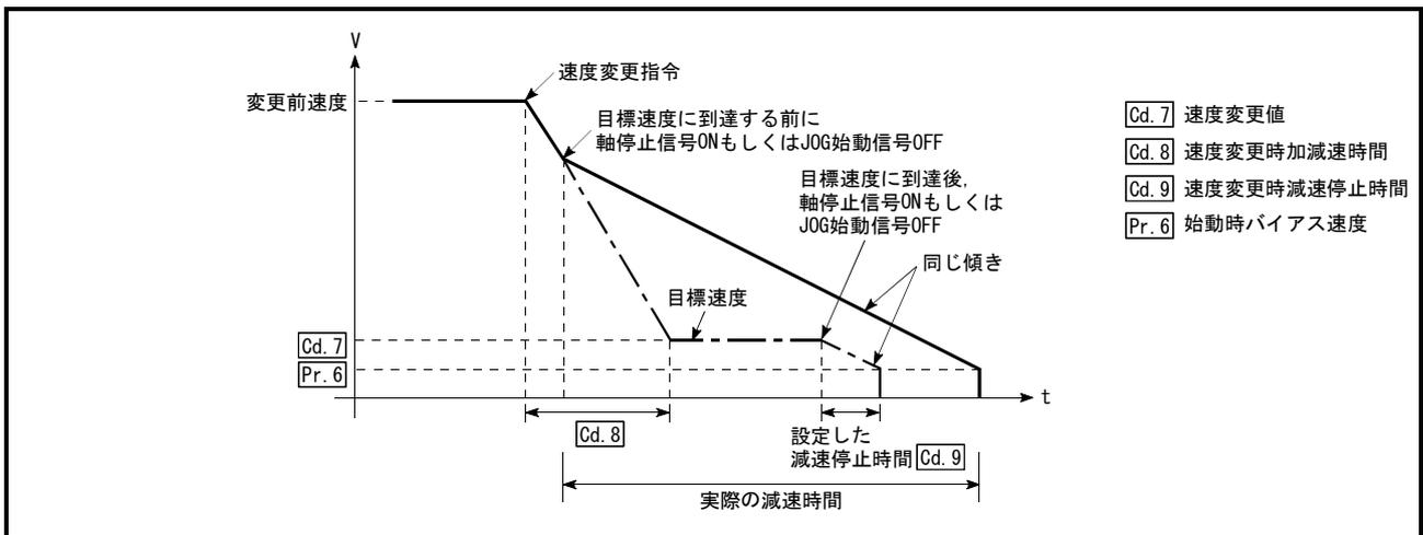
図11.2 速度変更値に到達する前に軸停止信号ONもしくはJOG始動信号OFFした場合の動作
