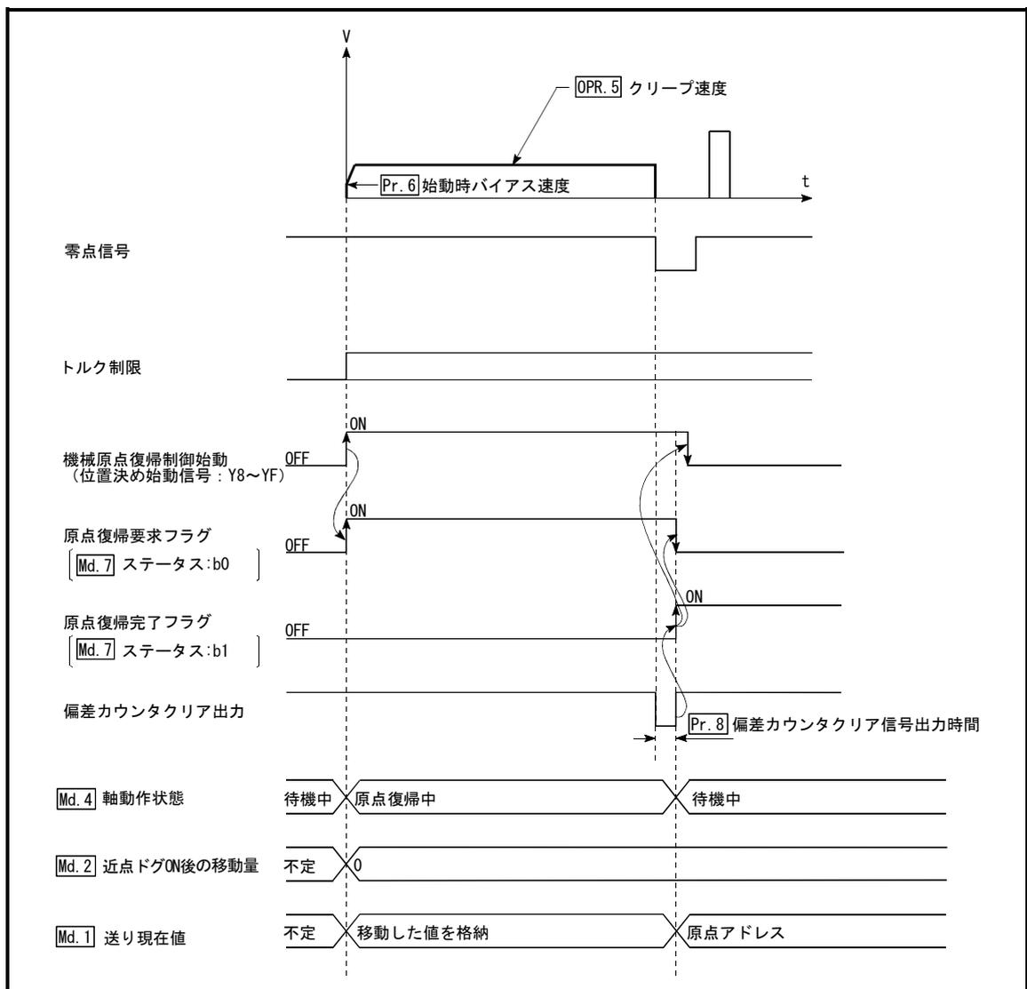
図8.9 ストップで停止する前に零点信号が入力された場合
