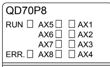
LEDの状態により、各軸のモニタができます。
