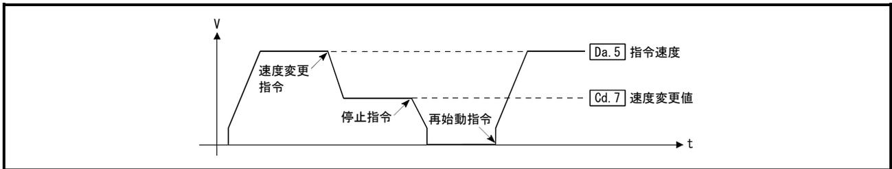
図11.4 速度・位置切換え制御の速度制御時における速度変更後の再始動速度
