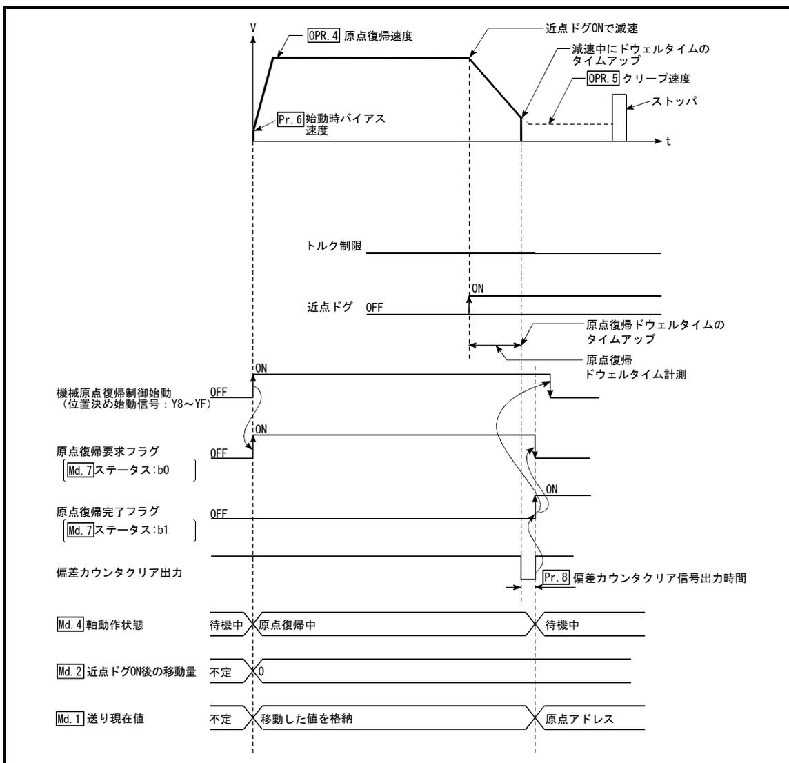
図8.5 原点復帰速度からの減速中にドウェルタイムが経過した場合の動作
