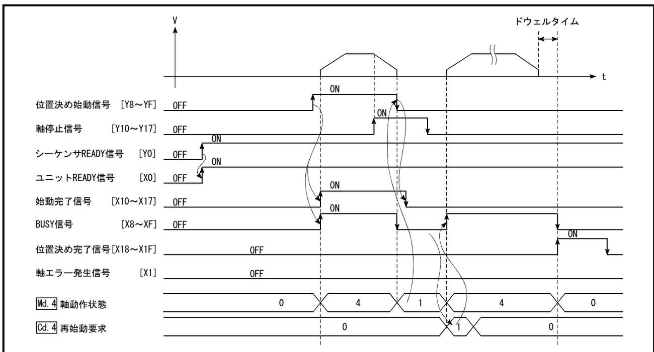
図7.9 再始動用タイムチャート (位置制御時)
