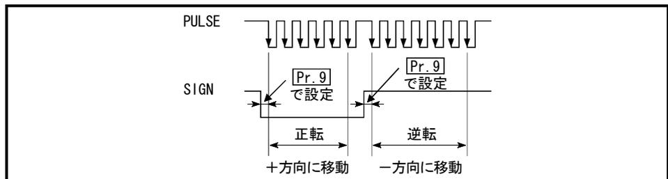
PULSE/SIGNモード (パルス出力モードはインテリジェント機能ユニットスイッチで設定 5.6節参照)
