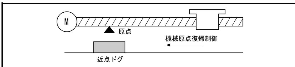
図8.1 機械原点復帰制御の例
