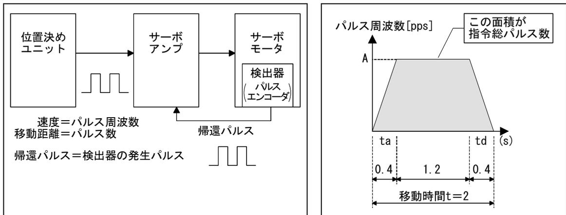
図1.1 位置制御と速度制御の関係
