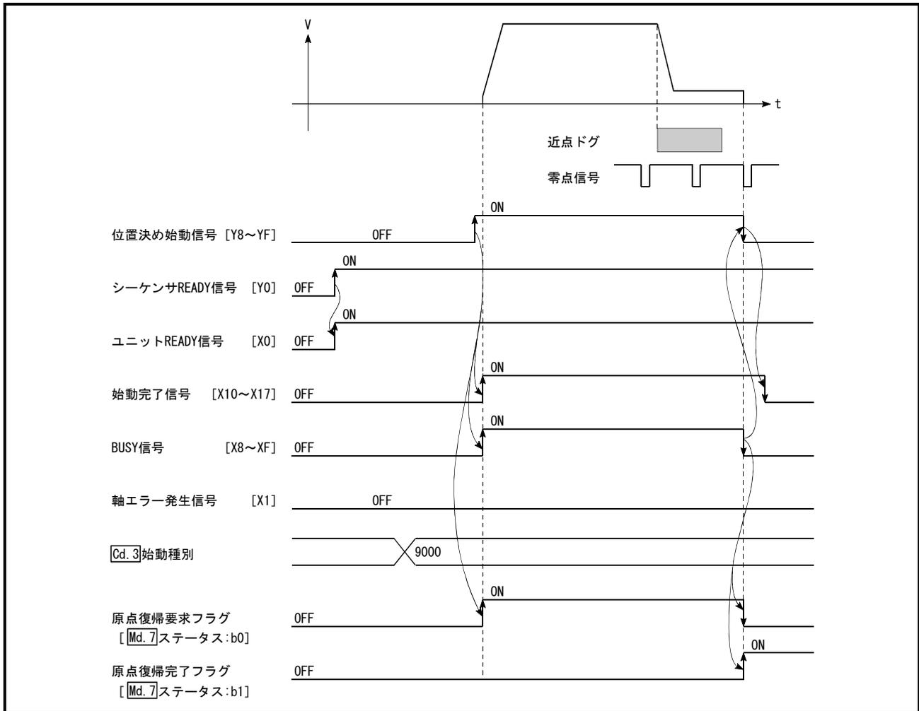
図7.4 機械原点復帰制御始動用タイムチャート
