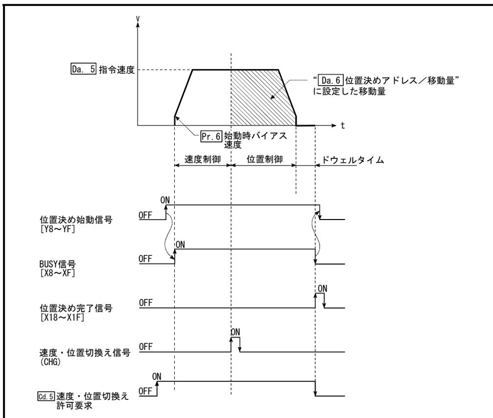
図9.8 速度・位置切換え制御の動作のタイミング
