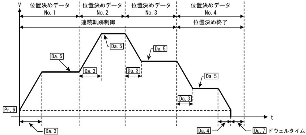
＜速度・位置切換え制御（位置決めデータNo. 1）の速度制御時の速度変更の場合＞
