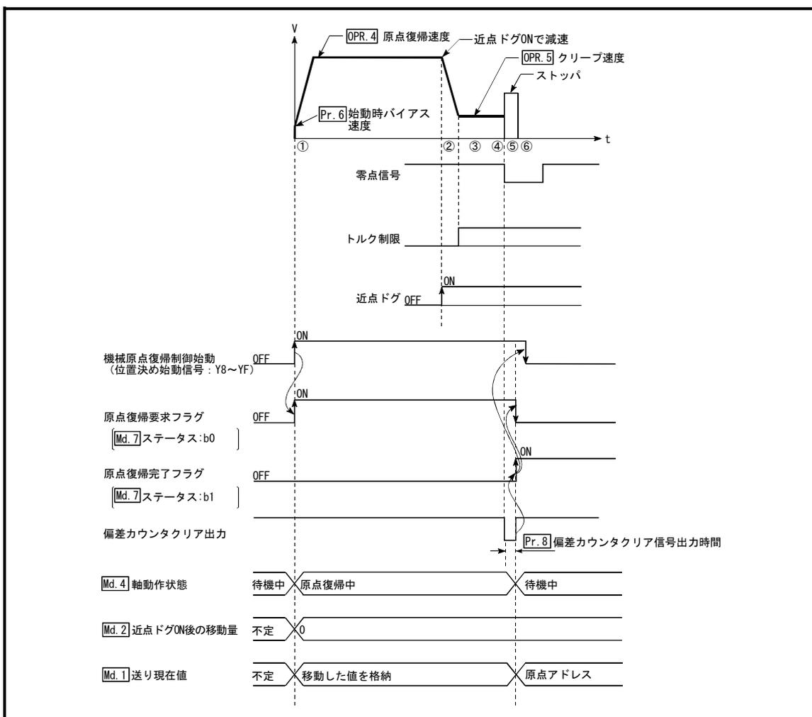
図8.6 ストップ2の機械原点復帰制御
