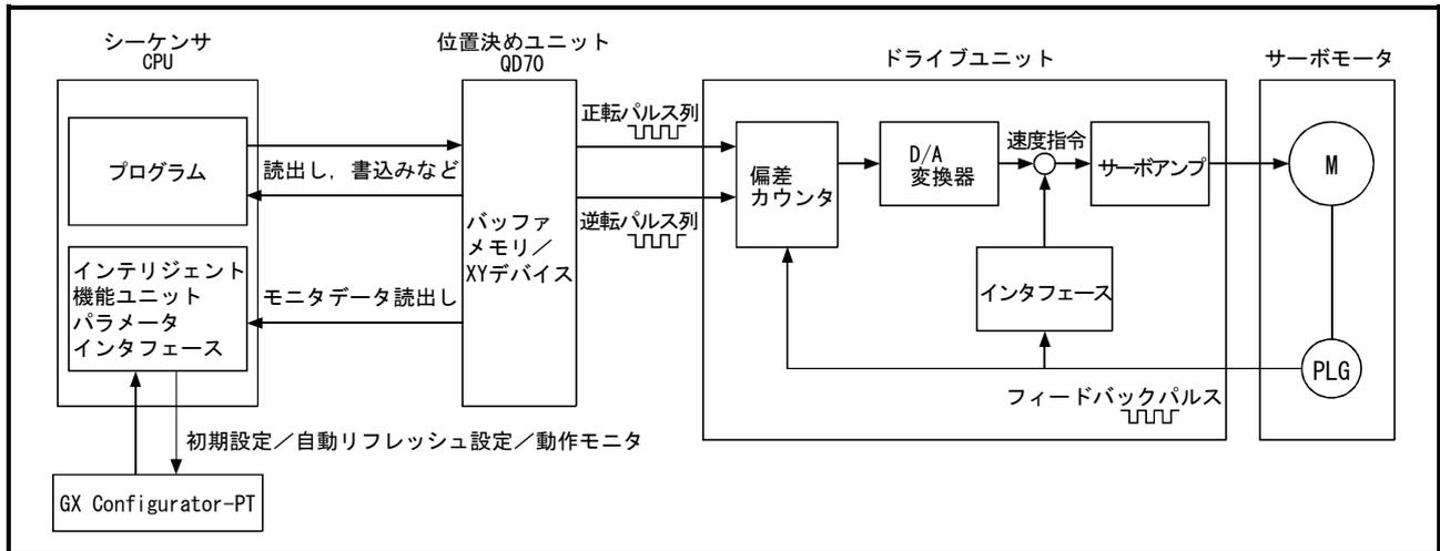
図1.2 QD70による位置決め制御システムの動作概要
