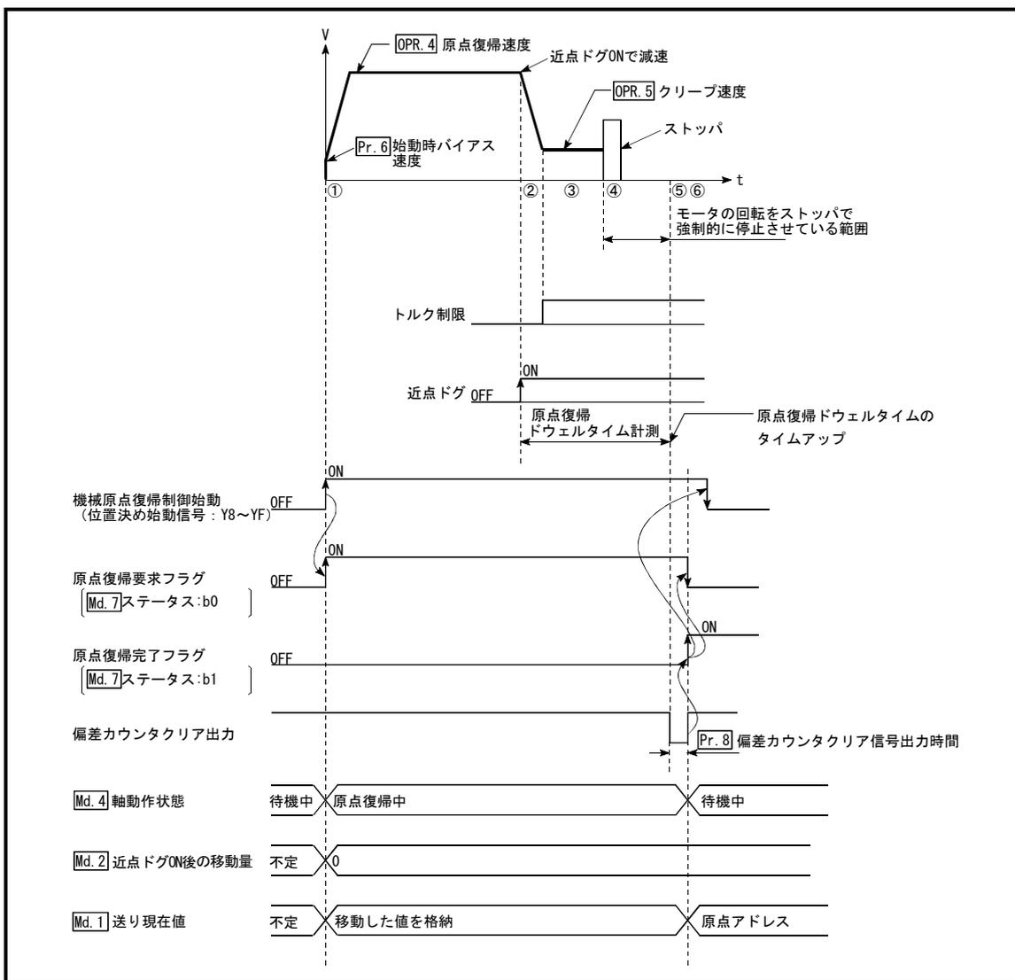
図8.4 ストップ1の機械原点復帰制御
