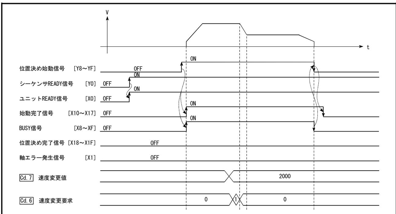
図7.8 速度変更用タイムチャート（速度・位置切換え制御の速度制御時）
