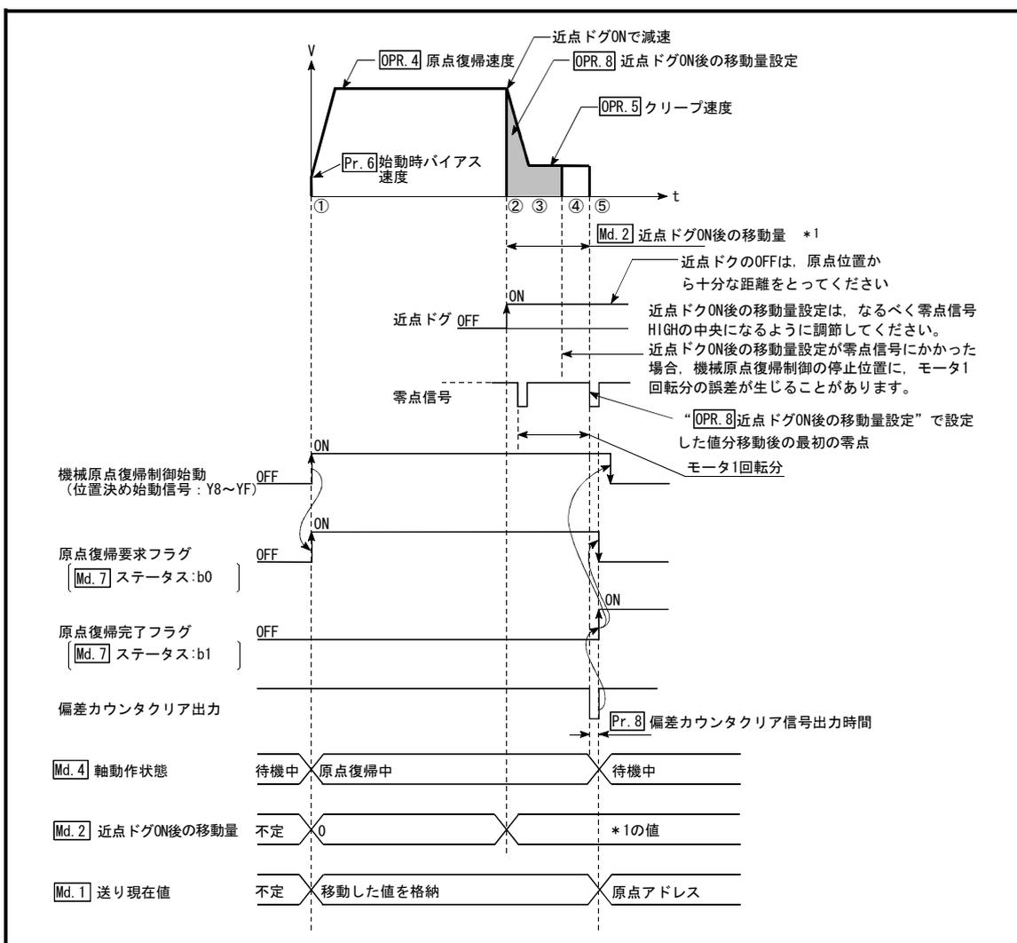
図8.10 カウント1の機械原点復帰制御
