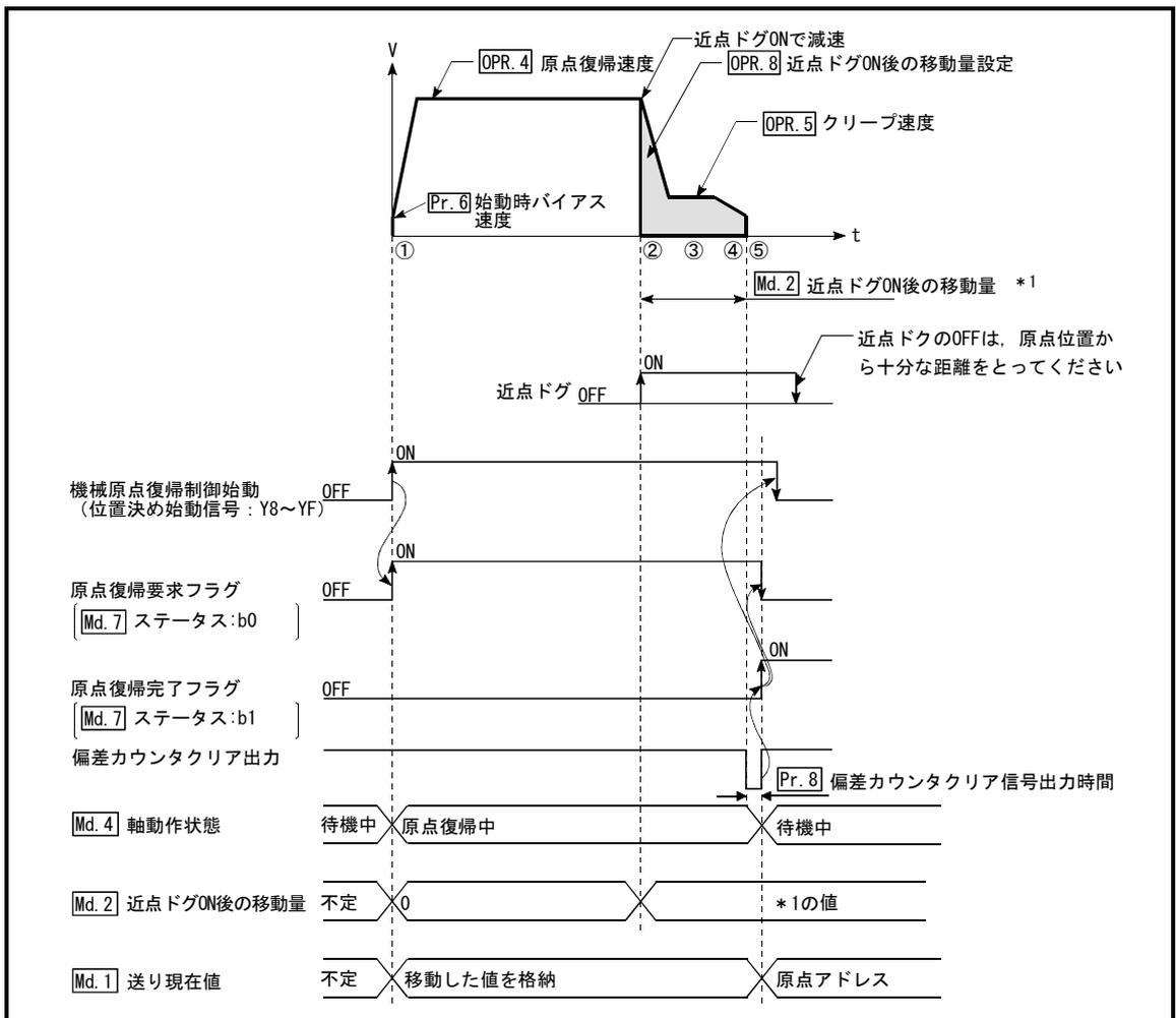
図8.11 カウント2の機械原点復帰制御
