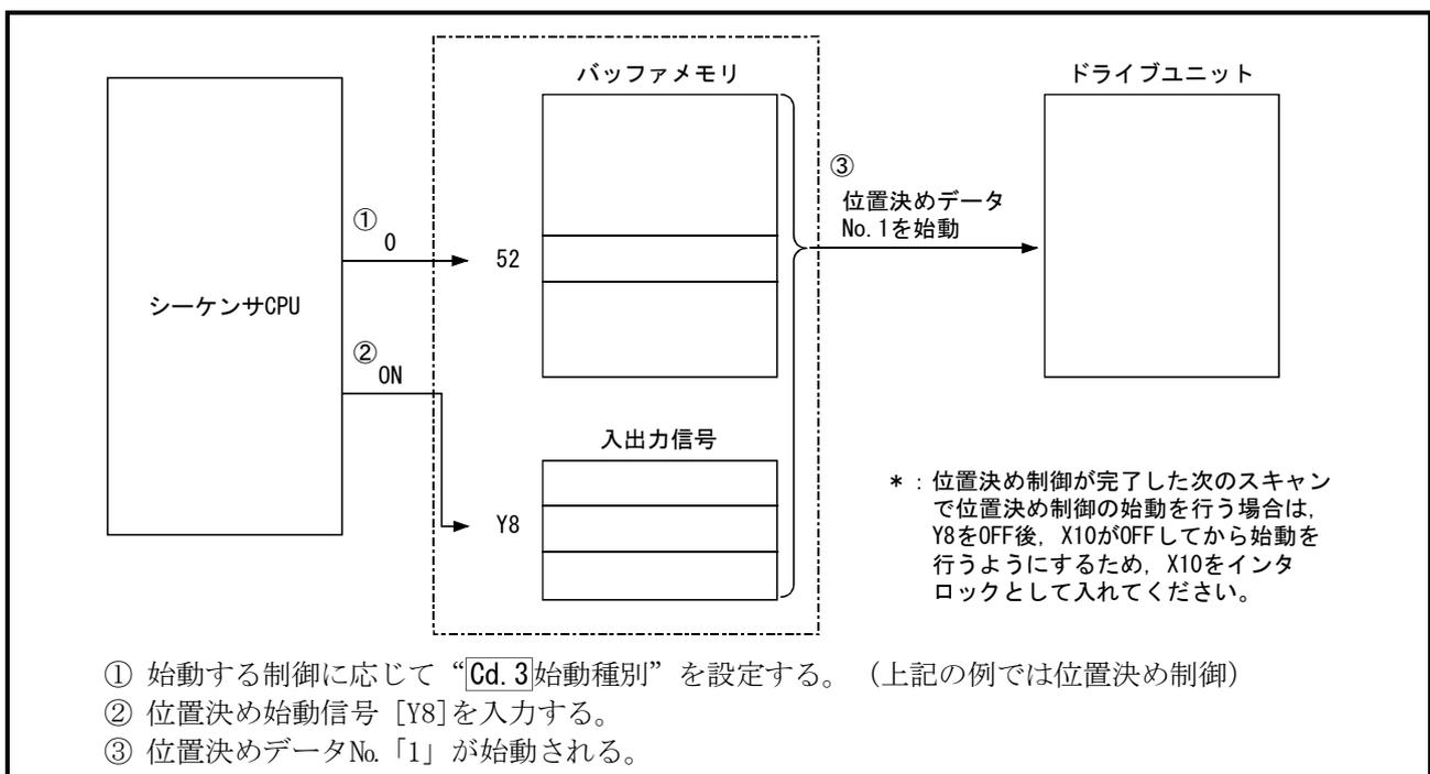
図7.2 制御始動の手順(軸1の場合)
