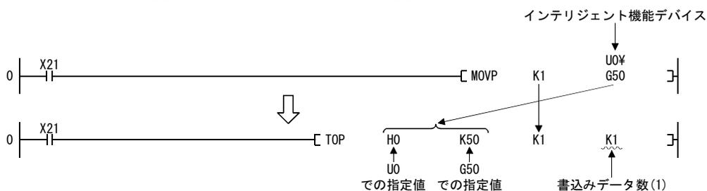
(b) MOV命令のソース(S)側とディスティネーション(D)側に“インテリジェント機能デバイス”を使用している回路はFROM命令とTO命令に変更します。
