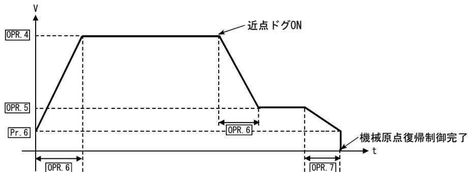
Pr. 6 始動時バイアス速度, OPR. 4 原点復帰速度, OPR. 5 クリープ速度
