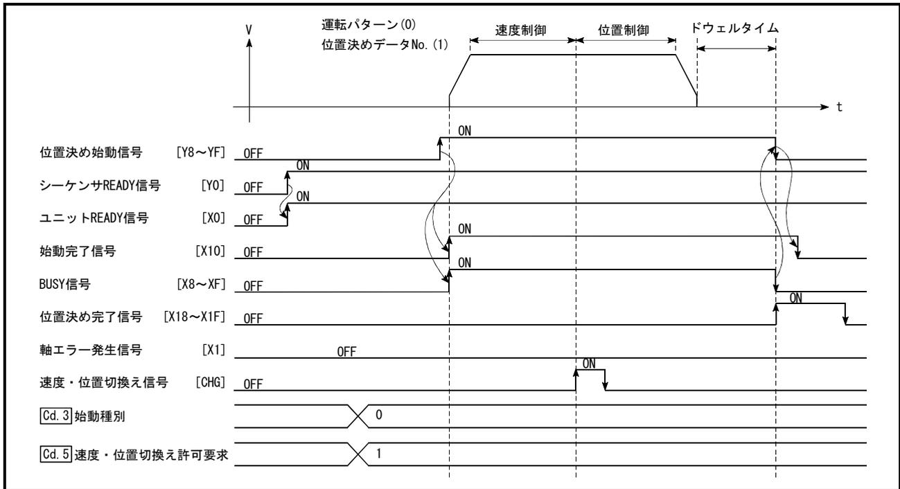
図7.7 速度・位置切換え制御始動用タイムチャート
