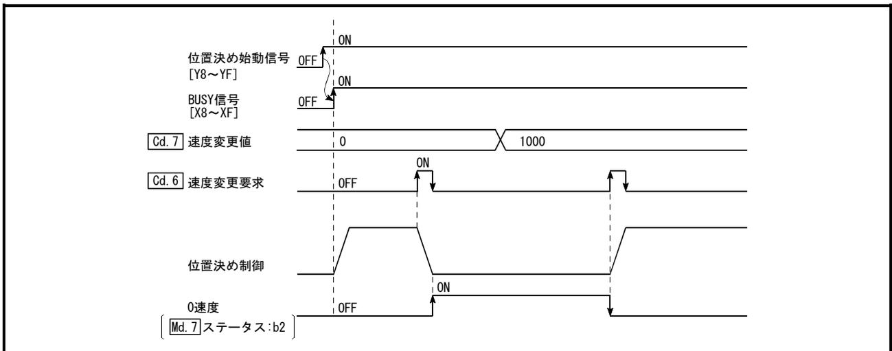
図11.3 速度変更値「0」での速度変更（速度・位置切換え制御の速度制御時）
