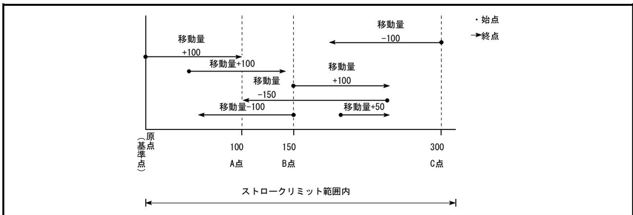
図9.6 インクリメント方式の位置決め制御
