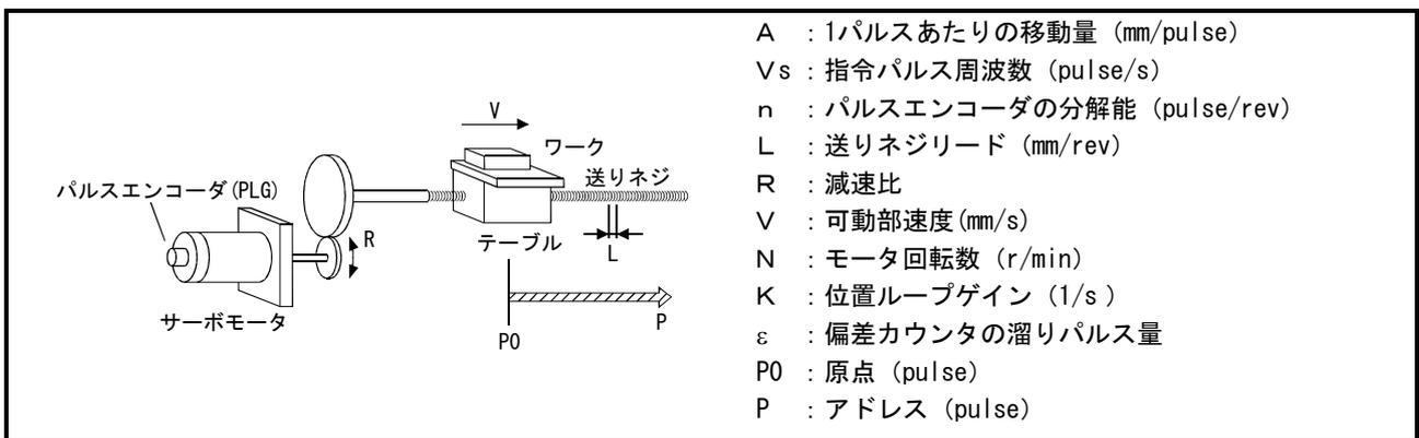
図1.4 ボールねじを使用したシステム
