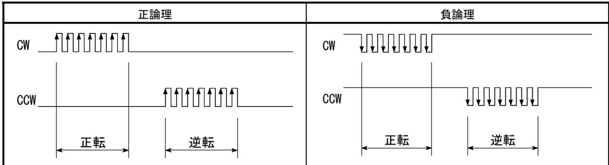
※CWは外部入出力信号の「PULSE F」，CCWは「PULSE R」から出力されます。（「3.4.3項」参照）
