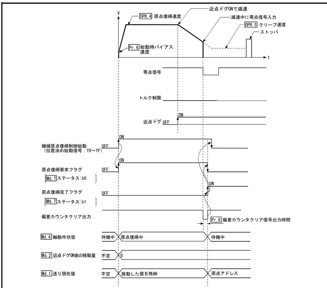
図8.7 クリープ速度まで減速する前に零点信号が入力された場合の動作
