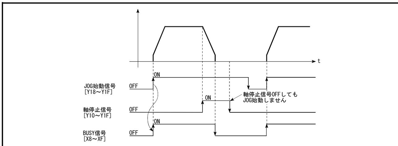
図10.5 JOG始動信号がONのままで軸停止信号をON→OFFした場合の動作
