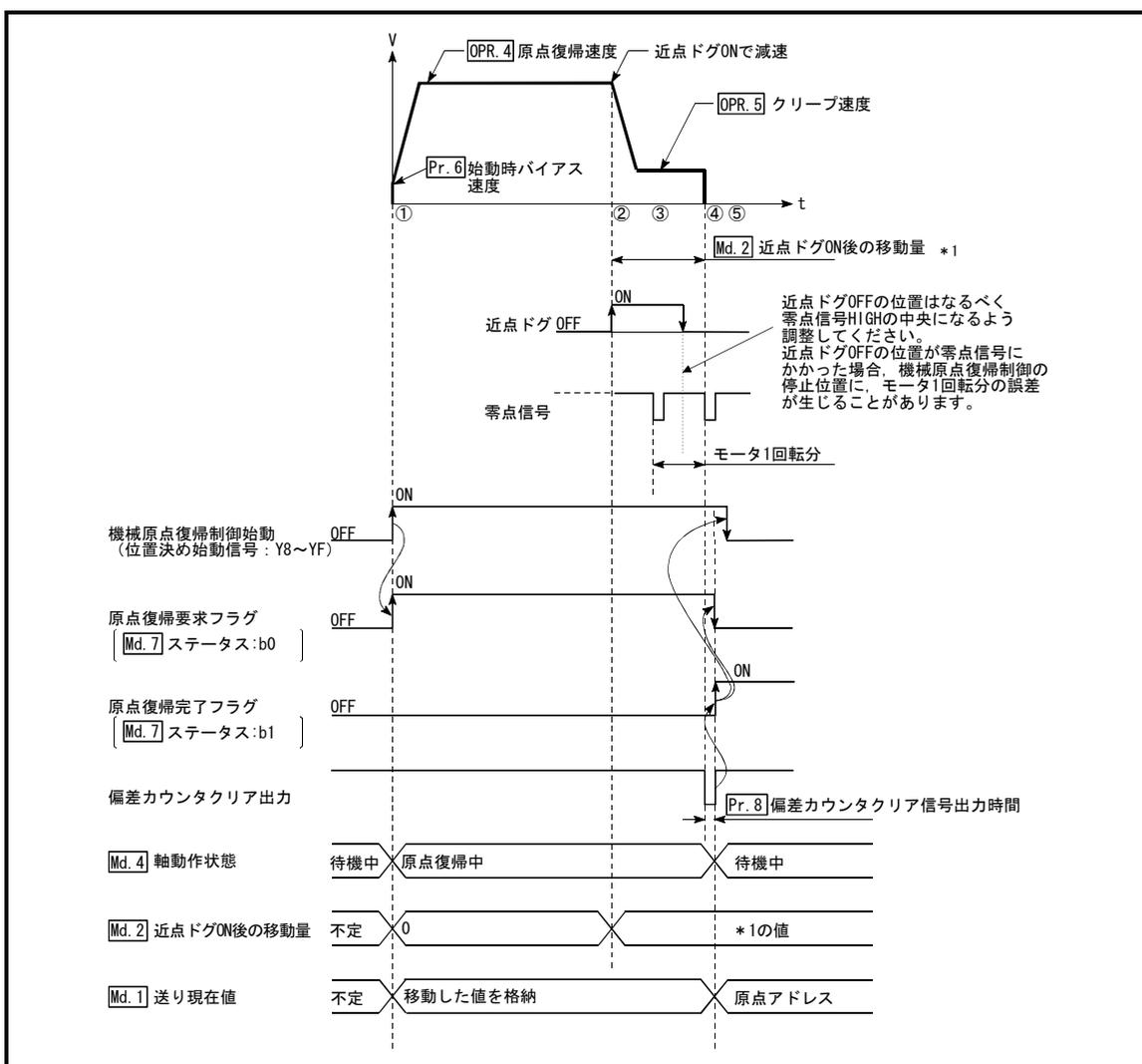
図8.2 近点ドグ式の機械原点復帰制御
