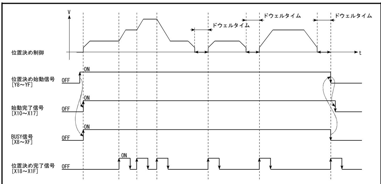
図7.3 位置決め制御始動時の各信号のON/OFFタイミング
