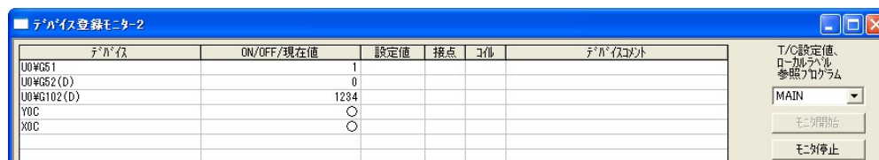
図7.7.4-1 デバイス登録モニタ画面(本ユニットがスロット0に装着された場合の例)
