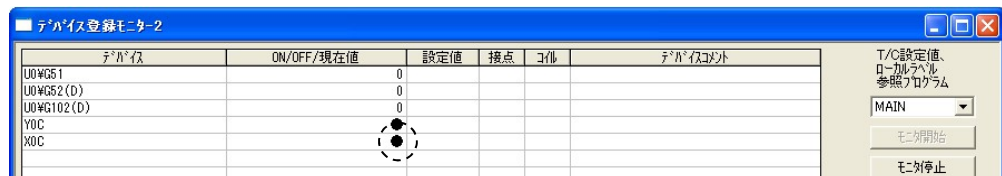
図7.7.4-3 デバイス登録モニター画面でのデバイス“XC”※の確認
