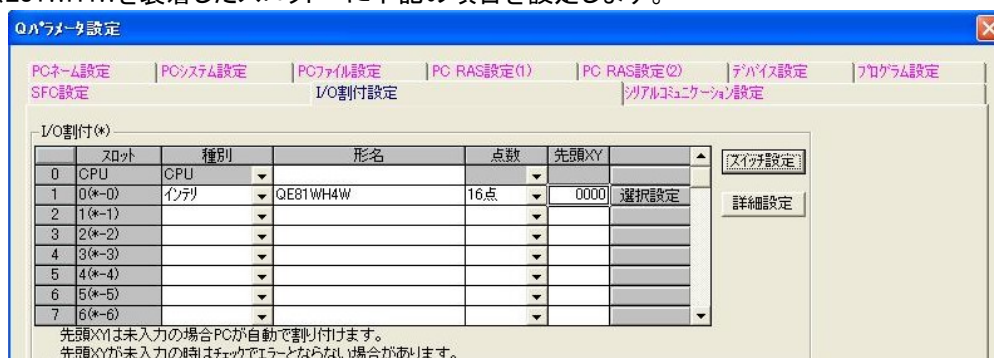
図7.7.1-1 “I/O 割付設定”タブのダイアログボックス
