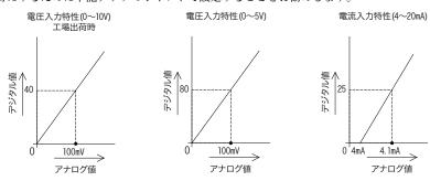
例えば $0\sim4000$ のデジタル値に対し $0\sim10$ Vのアナログ値に調整するばあいは、デジタル値が40のときに $40\times10$  (V) /4000=100mVに調整すればよいことになります。
