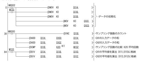
A/D入力データCH1 :D100 A/D入力データCH2 :D102 サンプリング回数 :D118
