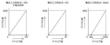
フルスケールのアナログ値で使用するばあい、電圧入力時はデジタル値が4000のときに10Vに調整します。 また、電流入力時はデジタル値が4000のときに20mAに調整します。
