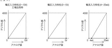
フルスケールのアナログ値で使用するばあい、電圧入力時はデジタル値が4000のときに10Vに調整します。 また、電流入力時はデジタル値が4000のときに20mAに調整します。
