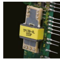
薄板式變壓器 使用纏繞線圈製成印刷電路板結構的超薄型變壓器，在不佔空間的情況下實現絕緣強度2000V AC。
