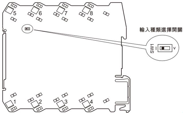
在使用 PC 設定軟體(型號: M6CFG) 變更輸入範圍之前, 需要先調整指撥開關設定輸入類型。
