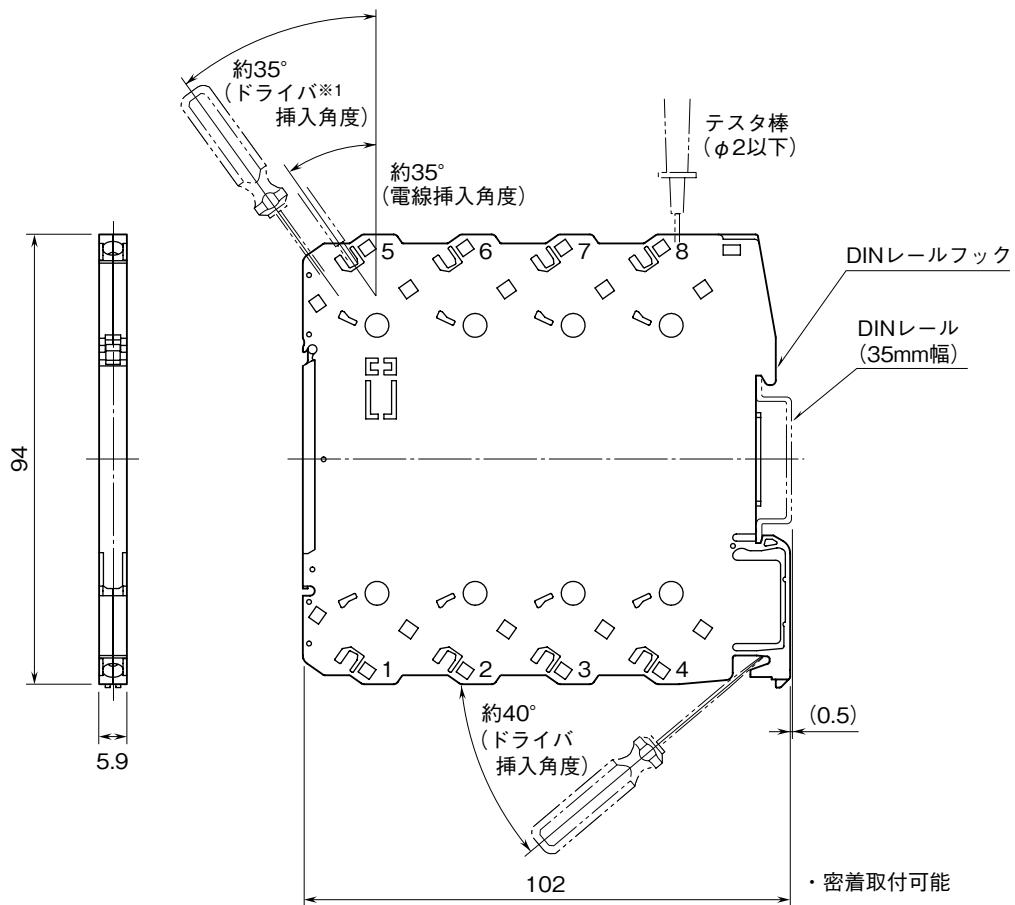
※1、ドライバは、先端サイズ 刃幅3.8mm以下、刃厚0.5~0.6mm程度のマイナスドライバを使用して下さい。
