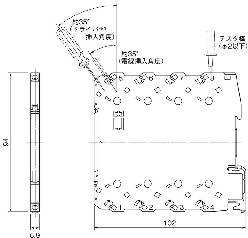
※1、ドライバは、先端サイズ 刃幅3.8mm以下、刃厚0.5~0.6mm程度のマイナスドライバを使用して下さい。
