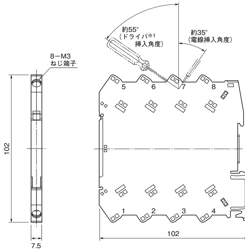
※1、ドライバーの軸径は、6mm以下のものを使用して下さい。
