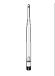
図 4.14 スリーブアンテナ
