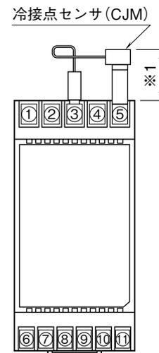
※1、冷接点センサのスペースを確保するため、20mm以上あけて下さい。
