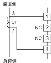
■制御出力 (Mv1、Mv2) 接続方法
