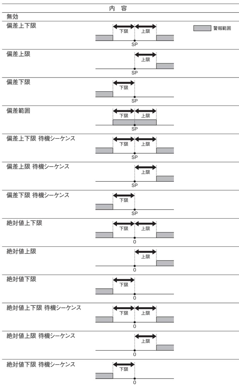
待機シーケンスとは、機器起動時や SP 変更時に意図しない警報を発生させないための機能で、起動後または SP 変更時に、PV が警報動作範囲外に達するまで警報を発生しないようにします。
