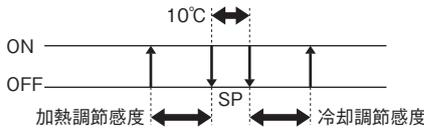
PID 制御のときは、P 制御に対してデッドバンドが有効となります。P 動作 ( $I = 0$ 、 $D = 0.0$ ) のときにデッドバンドを 10℃に設定すると、下図左のように SP ± 5℃の領域で加熱 MV も冷却 MV も 0 の領域ができ、デッドバンドを -10℃に設定すると、下図右のように SP ± 5℃の領域で加熱 MV も冷却 MV も 0 以外の領域ができます。
