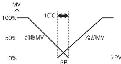
注) 図はわかり易くするために P 動作時の MV 動作を表していますが、I、D が設定されている場合は、加熱 MV / 冷却 MV の切替わりが SP と一致しないため、図の通りにはなりません。
