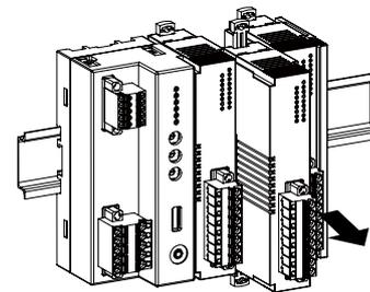
注1、内部通信バス用コネクタは先端がとがっているのので、怪我をしないように注意して下さい。
