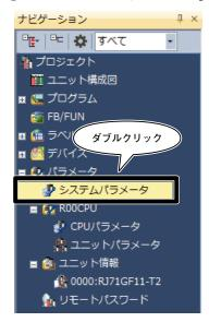
② [ユニット間同期設定] タブをクリックします。 [システム内でユニット間同期機能を使用する] - [使用する] を選択します。
