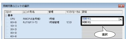
④ [ユニット間同期の定周期間隔設定] を 0.05 ms 単位で設定しない場合、[定周期間隔設定 (0.05 ms 単位で設定しない)] の項目でプルダウンメニューから設定値を選択します。
