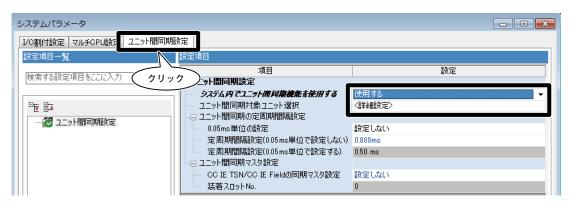
③ [ユニット間同期対象ユニット選択] - <詳細設定>をクリックし、同期対象とするユニットの設定を [同期する] に変更し、[OK] をクリックしてウィンドウを閉じます。
