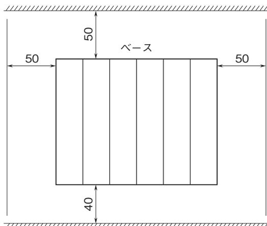
盤の底板、配線ダクト (高さ50mm以下) を示す。
