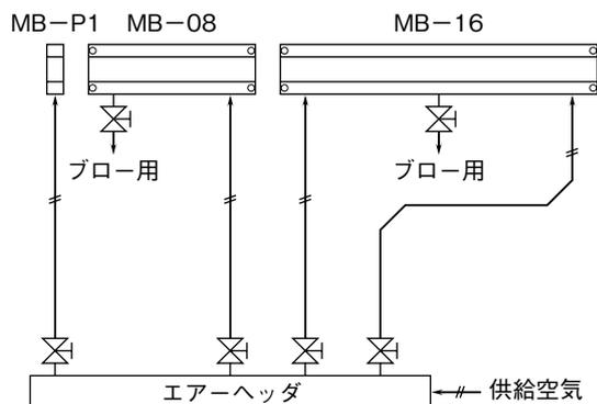
使用される配管のサイズは、必要な流量に応じて選定して下さい。また、保守点検が容易になるよう、エア-ヘッドからマウントブロックとの配管の途中にコックを設置して下さい。
