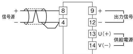
注) 本器は超高速形のため原理的に入力信号に含まれるノイズだけを変換器内で減衰させることはできません。したがって「シールド付より対線」を使用するなど入力信号にノイズが混入しないように十分ご注意ください。
