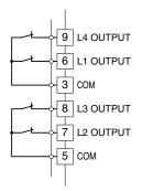
• OUTPUT CODE 5: SPDT Relay
