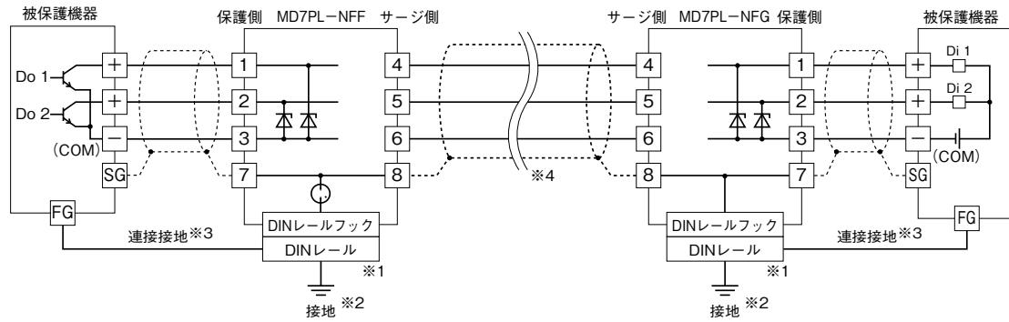
※1、アルミニウム製DINレールは、酸化皮膜によって本器と接地の導通性を阻害する恐れがあります。鉄や銅製のレールをご使用下さい。
