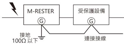
確保將線路連接到受保護設備的外殼和 M-RESTER 的接地端子上。
