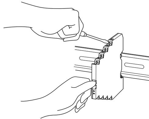
端子の締め付け、緩め作業は前面に手を添えて行って下さい。
