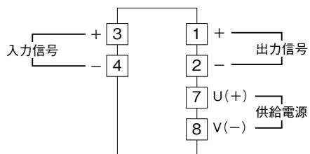
注) インバータのFM端子には変換器以外を接続しないで下さい。
