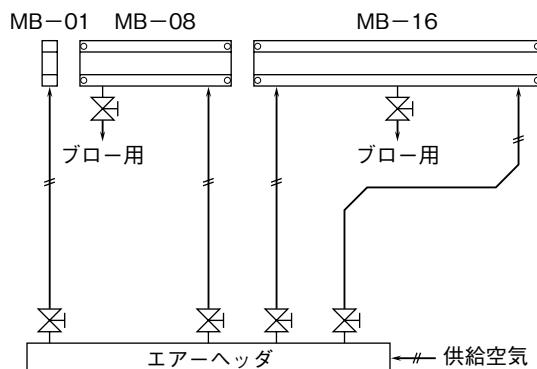
使用される配管のサイズは、必要な流量に応じて選定して下さい。また、保守点検が容易になるよう、エアーヘッダからマウントブロックとの配管の途中にコックを設置して下さい。
