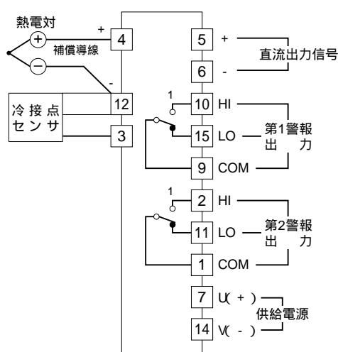
1. 警報出力形式コード“1、4”的ときの電源OFF時の接点状態です。
