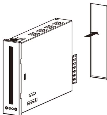
本体を前面より押し込むだけで取付けができます。
