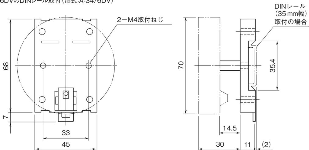
■26・UNIT+6DVのDINレール取付(形式:A-34/266)
