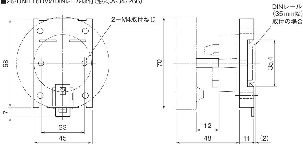
■27・UNIT+6DVのDINレール取付(形式:A-34/276)
