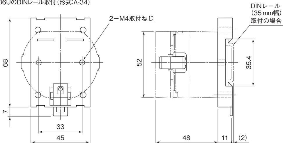
注、液晶表示部の取外しのため、指が入る寸法間隔で取付けて下さい。
