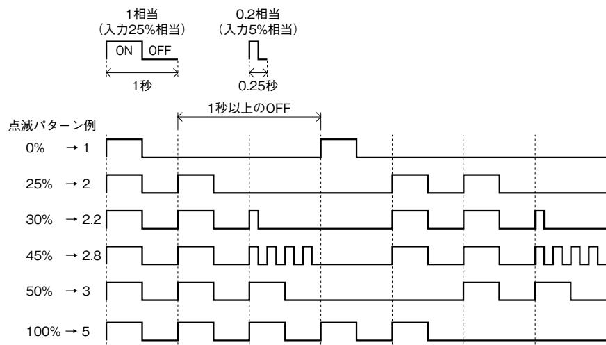
■異常モニタ：機器の異常状態を、以下の点滅パターンで表示します。
