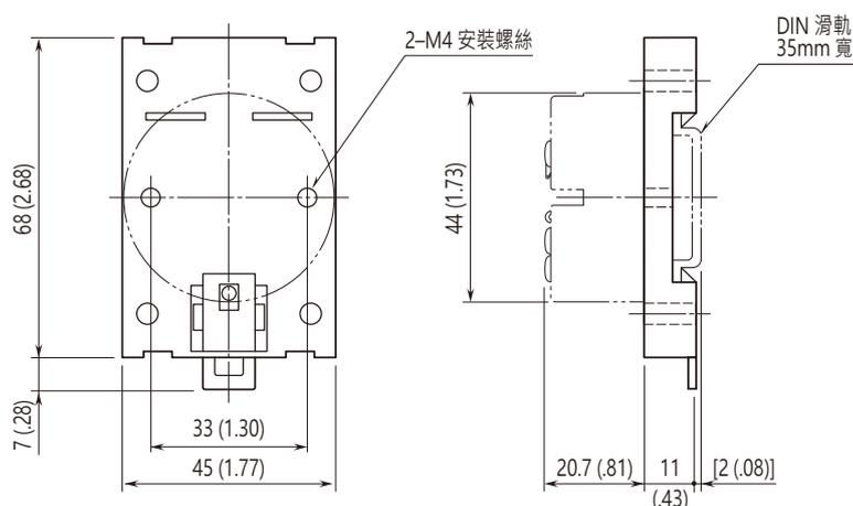
■ 將 6DV 安裝到 DIN 滑軌上 (型: A-34/6DV)
