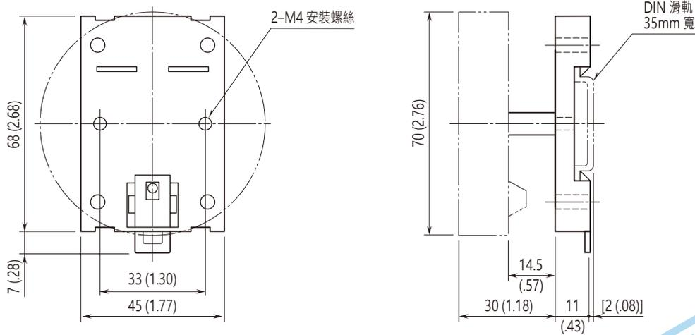
■ 將 26-UNIT + 6DV 安裝到 DIN 滑軌上 (型號: A-34/266)
