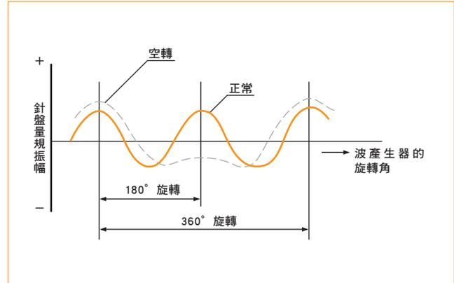
測量彈性齒杯胴部振幅
