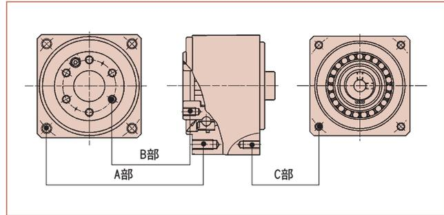
在軸輸出中，安裝滑輪、小齒輪等時，請勿對輸出軸施加衝擊。將導致減速機精度劣化或故障。
