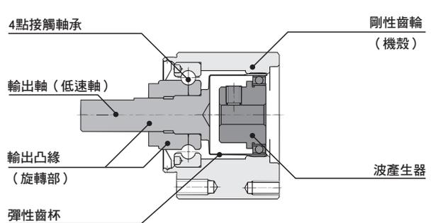
※ 當固定住剛性齒輪（機殼）時，輸出軸的旋轉方向會和輸入軸（波產生器）的旋轉方向相反。
