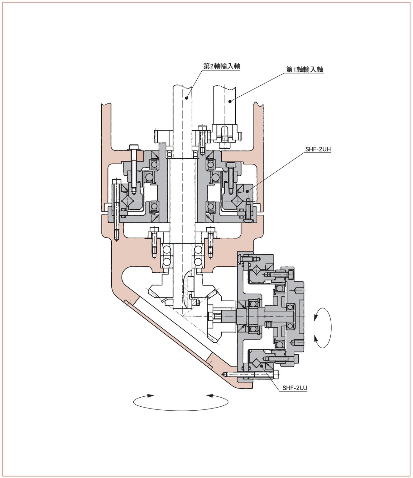
在 SCARA 型機械手臂基本 2 軸上，組裝簡易模組型（2SO）（沒有輸出輸入凸緣的類型）的例子
