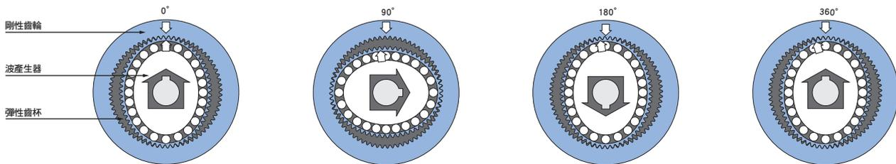
彈性齒杯會受波產生器拉寬為橢圓狀。因此在長軸部位上，彈性齒杯的齒槽會和剛性齒輪互相嚙合；但在短軸部位上，齒槽則是呈完全分離的狀態。
