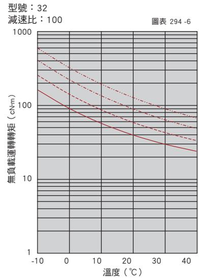
輸入轉速 ——— 500r/min    - - - - - 1000r/min    - · - · - · 2000r/min    ······ 3500r/min
