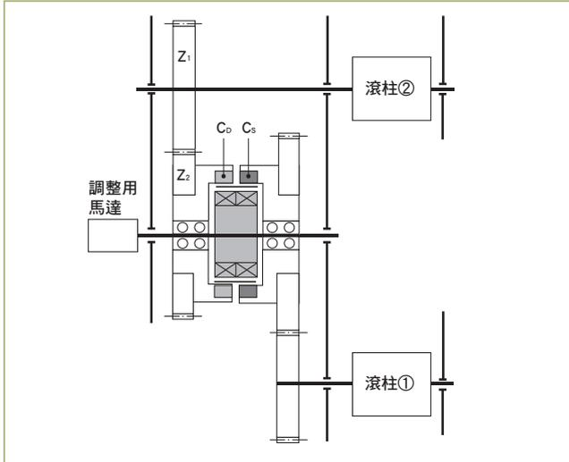
本裝置是調整 2 個滾柱的相位的調整裝置，一般會讓調整用馬達進入煞車狀態，以主驅動循滾柱①→Cs→Co→滾柱②的方式使其旋轉。若在此處須調整滾柱②對於滾柱①的相對相位時，便必須讓調整用馬達旋轉。調整後須停下調整用馬達，讓滾柱②返回至最初的旋轉狀態。
