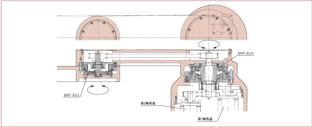
在直角坐標機器人的手腕軸上，組裝中空型（2UH）與附輸入軸型（2UJ）的例子
