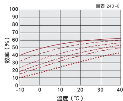
輸入轉速      ————— 500r/min      - - - - - 1000r/min      - - - - - 2000r/min      - - - - - 3500r/min
