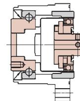
※當固定住剛性齒輪 (機殼) 時，輸出軸的旋轉方向會和輸入軸 (波產生器) 的旋轉方向相反。
