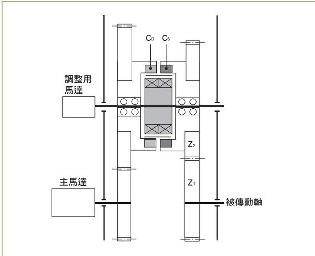
本方法是當必須微調被傳動軸的速度、時序時，不必改變主馬達的轉速便能以調整用馬達進行調整的方式。
