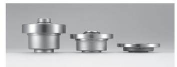
ハーモニックドライブ®は、その誕生以来常に進化を続けています。1981年のCSシリーズと、現在主力のCSFシリーズでは、その厚さが5分の3になり、動力伝達も2倍となっています。さらに次世代のCSDシリーズは、CSシリーズの実に3分の1の厚さで、高トルクと、回転精度を引き出す事に成功しています。
